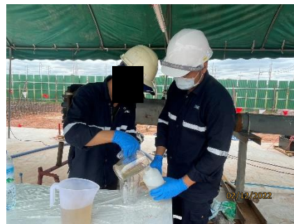
รูปที่ 3-8 การติดตามตรวจสอบคุณภาพน้ำทั้งจากการทดสอบท่อด้วยวิธีทางชลสถิต (Hydrostatic Test)
